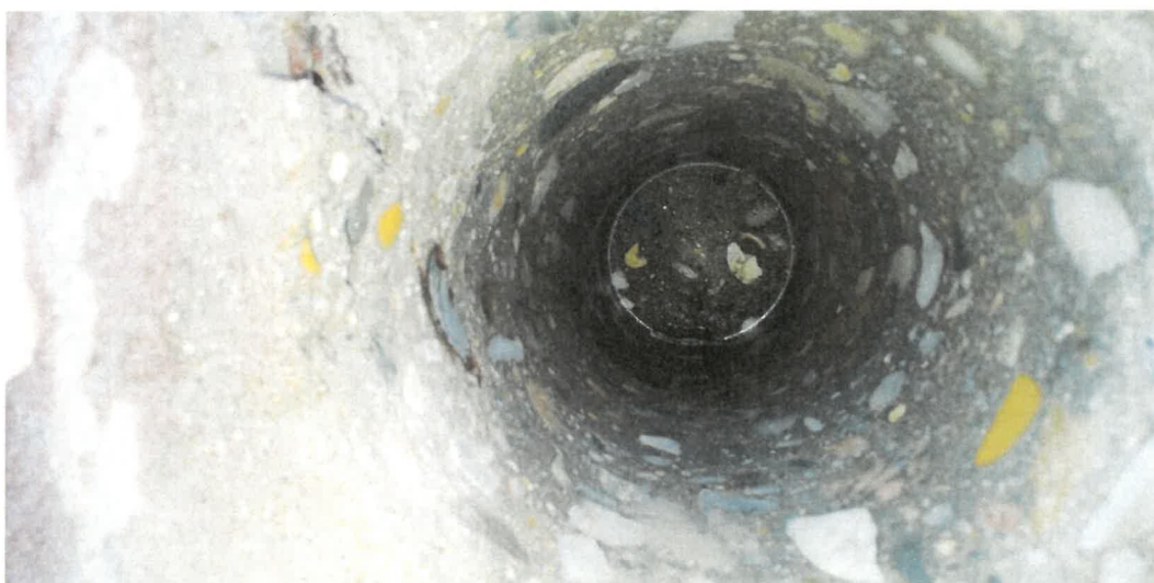
Obr. 21: Pohled do sondy po odběru jádrového vývrtu č. 6 – struktura betonu není narušena.
