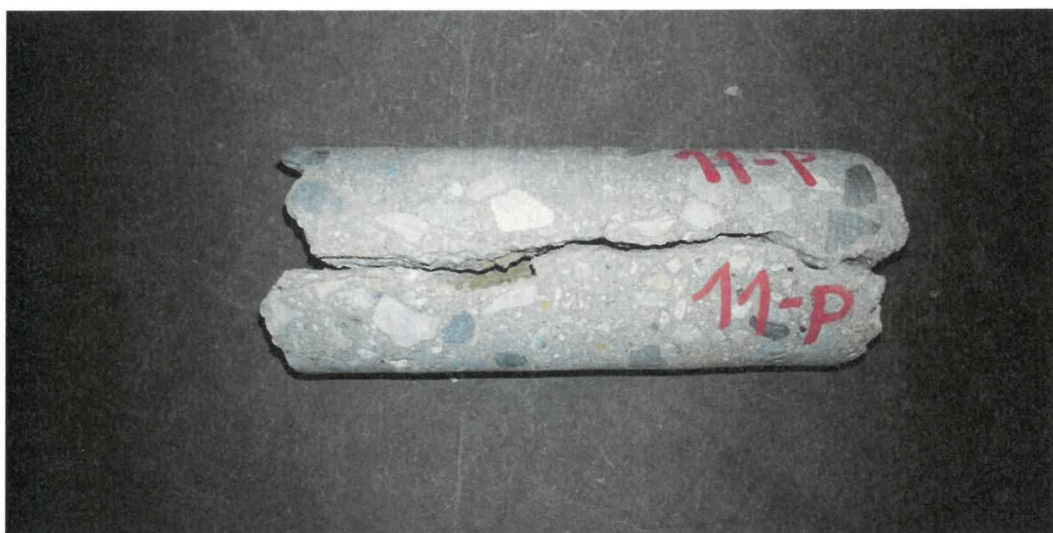
Obr. 36: Nepropojená vodorovná pracovní spára v jádrovém vývrtu č. 11-P.
