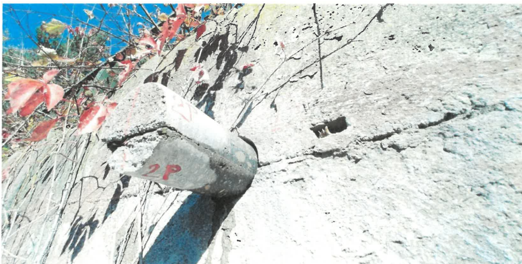
Obr. 16: Sonda po odběru jádrového vývrtu č. 2-P, který byl odebrán v místě vodorovné pracovní spáry.
