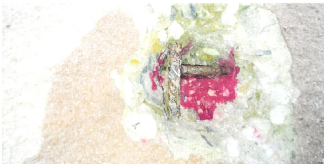
Obr. 11: Detail stykování svislého a vodorovného prutu betonářské výztuže. Pomocí fenolftaleinu byla identifikována oblast cementové matrice, která je schopna svým pH chránit betonářskou výztuž před korozí. Tato oblast se nachází až za betonářskou výztuží.
