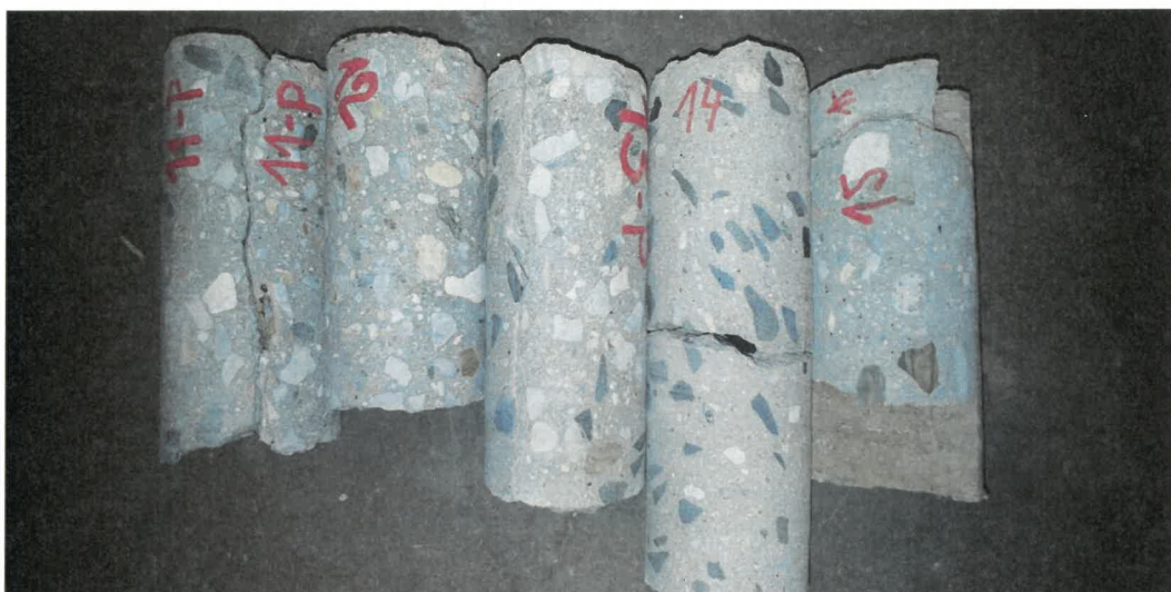
Obr. 32: Pohled na odebrané jádrové vývrty – série vývrtů č. 11-P až 15-D.
