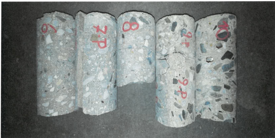
Obr. 31: Pohled na odebrané jádrové vývrty – série vývrtů č. 6 až 10.
