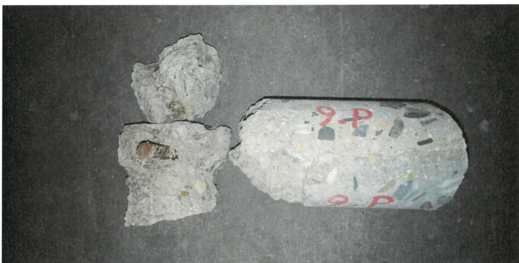
Obr. 35: Mezerovitá struktura betonu a otevřená vodorovná pracovní spára v povrchové části jádrového vývrtu č. 9-P.
