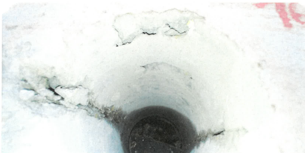
Obr. 29: Pohled do sondy po odběru jádrového vývrtu č. 16-P – pracovní spára je otevřená do hloubky cca 170 mm. U povrchu konstrukce se v betonu vyskytuje mezerovitá struktura a štěrková hnízda do velikosti 35 mm. Tato povrchová oblast byla dále narušena trvalým zatékáním vody a zmrazovacími cykly.
