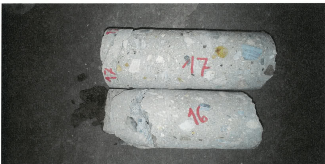
Obr. 33: Pohled na odebrané jádrové vývrty č. 16-P a 17.
